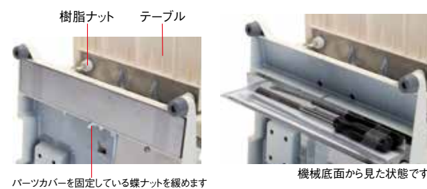
パーツカバーを固定している蝶ナットを緩めます
